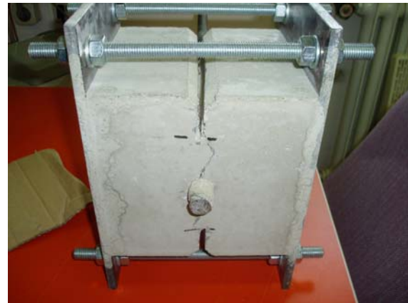
Bild 5: Vorrichtung zur Einstellung der Rissbreiten: Konstruktion und Ausführung.
