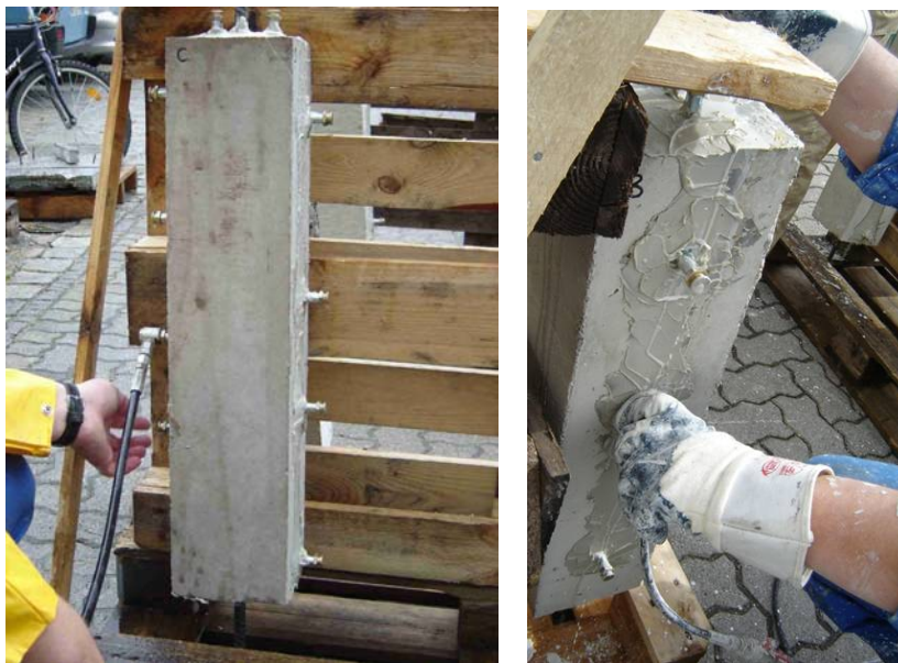
Bild 4: Verpressen der Versuchskörper mit Zementsuspension.
